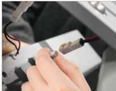
Paso 5 Conecte el nuevo chevron LED mediante los conectores existentes.
