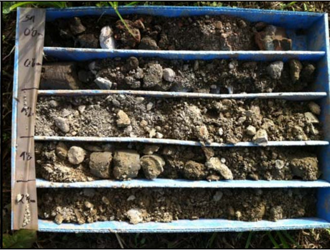
Foto 2.- caixes testimoni de l'assaig P-1 de 0.00 a 3.00 metres.
