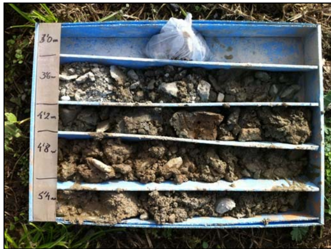
Foto 3.- caixes testimoni de l'assaig P-2 de 3.00 a 6.00 metres.
